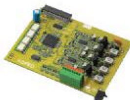
T-Modul 204 Art.-Nr. 143021 Das T-Modul 204 besitzt vier Ports für analoge Nebenstellen. Durch die integrierte CLIP-Funktion ist es möglich, am analogen Endgerät die Rufnummer des Anrufers übermittelt zu bekommen (abhängig vom Endgerät).
